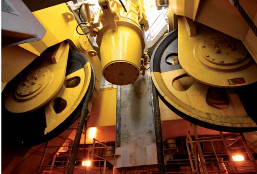
dos maquinillas no operarán, probablemente, al mismo tiempo, sí que resultan necesarias para asegurar el tiro en la maquinilla de tracción. En este sentido, dos cilindros de tensión hidráulicos son los que corrigen y aseguran las diferencias de velocidad e inercia entre la maquinilla de tracción y la de almacenamiento.
