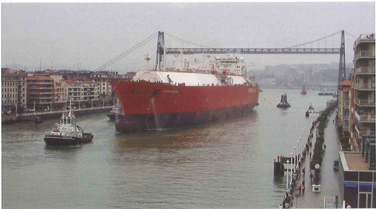
Como factor con notable influencia en la maniobrabilidad y en la seguridad de las maniobras del buque en las terminales de carga y descarga, se ha tenido en cuenta un valor máximo del calado aéreo de 44,90 m desde la flotación y 54,65 m desde la línea base.
