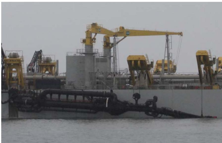
costados del buque, cada uno de ellos de 1.200 mm de diámetro, que se hunden en el agua hasta una profundidad de 93,50 metros desde la línea de flotación del buque con la cántara vacía.
